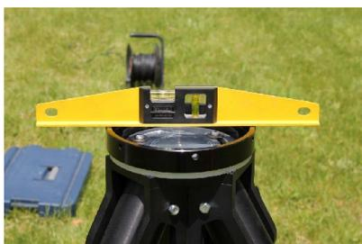
La boussole vers le Nord, et niveau pour bien dégrossir les réglages ...
