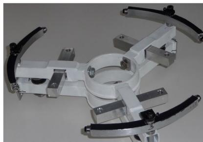
Pour les points d'appui latéraux : le but est de soutenir le miroir lorsqu'il repose sur sa tranche. MESIC nous donne la déformation théorique directement en nanomètre. En effectuant le rapport avec une longueur d'onde (le vert a 500nm comme pour le P-V) on trouve l'erreur que l'on inflige au miroir dans cette position.
