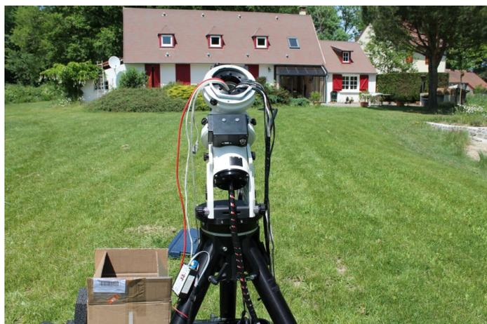
Tous les câbles sont insérés à travers les deux axes avant d'être maintenus par la platine supérieures ...
