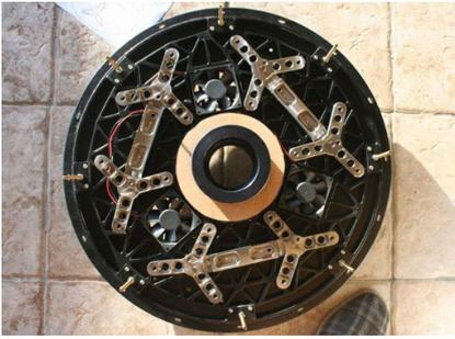
18 points ? Oui, mais sans trop en abuser pour des diamètres importants car sinon l'erreur résultant va augmenter et ne plus être si négligeable que cela. De plus, il peut être réalisé en mode « slim » (je fais un autre 254mm sur ce principe)
