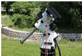
La double-platine est installée sur l'AP et la barre de contreponds vissée ....
