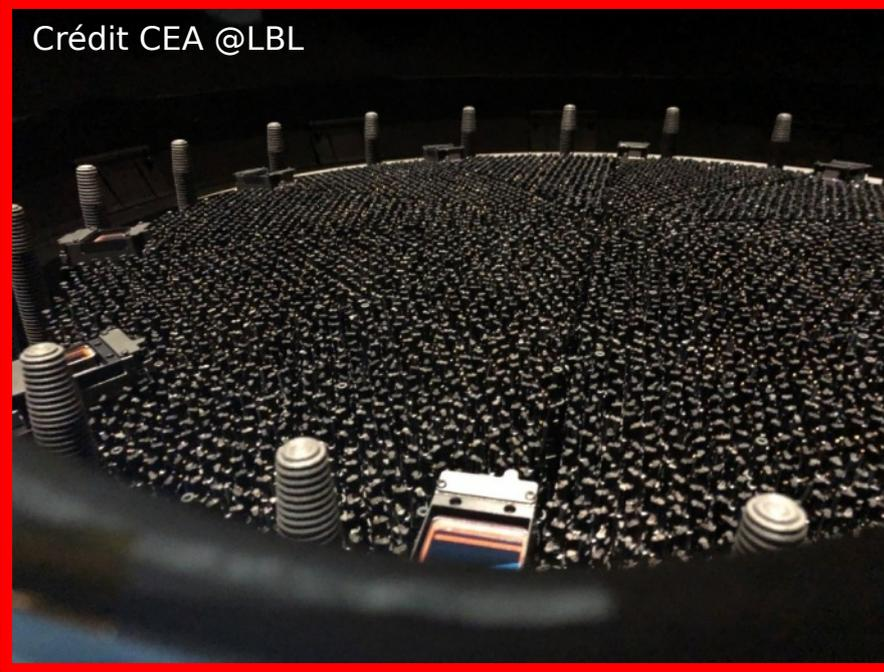
Dans une autre catégorie, voici le système de spectroscopie du télescope Mayall à Kitt Peak (USA).
