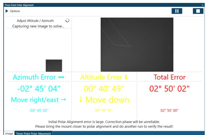
On agit alors sur les vis azimut et d'altitude de la monture, les erreurs se mettent à jour automatiquement et on visera des erreurs inférieures à la minute d'arc.
