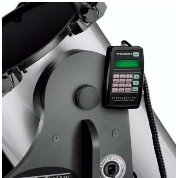
Pour pouvoir l'utiliser il faut commencer par le calibrer. Il lui faut 3 points: Le premier est immédiat : le tube doit être en position verticale. Il y a une cale qui a été ajustée et il n'est pas nécessaire d'avoir le télescope parfaitement à niveau (Et heureusement, car dans la pelouse cela aurait été compliqué).
