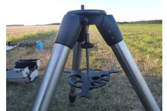
J'installe la monture sur le trépied en insérant le trou de centrage sur le pion de centrage du trépied (si besoin desserrer les vis d'azimut pour faciliter le montage).
