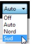
Attention quand même au guidage dans un seul sens, si la courbe DEC « s'inverse » dû à une longue oscillation, une rafale de vent, des corrections sont donc nécessaires dans l'autre sens...
