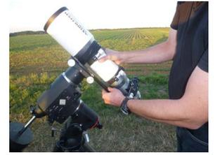
Je retire le couvercle de la lunette et le coulant situés aux deux extrémités de la lunette pour la mise en température.
