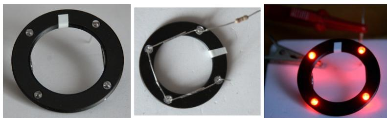
1. Insertion des LED's 3mm dans les 4 trous de 3 mm de la bague ZWO.
