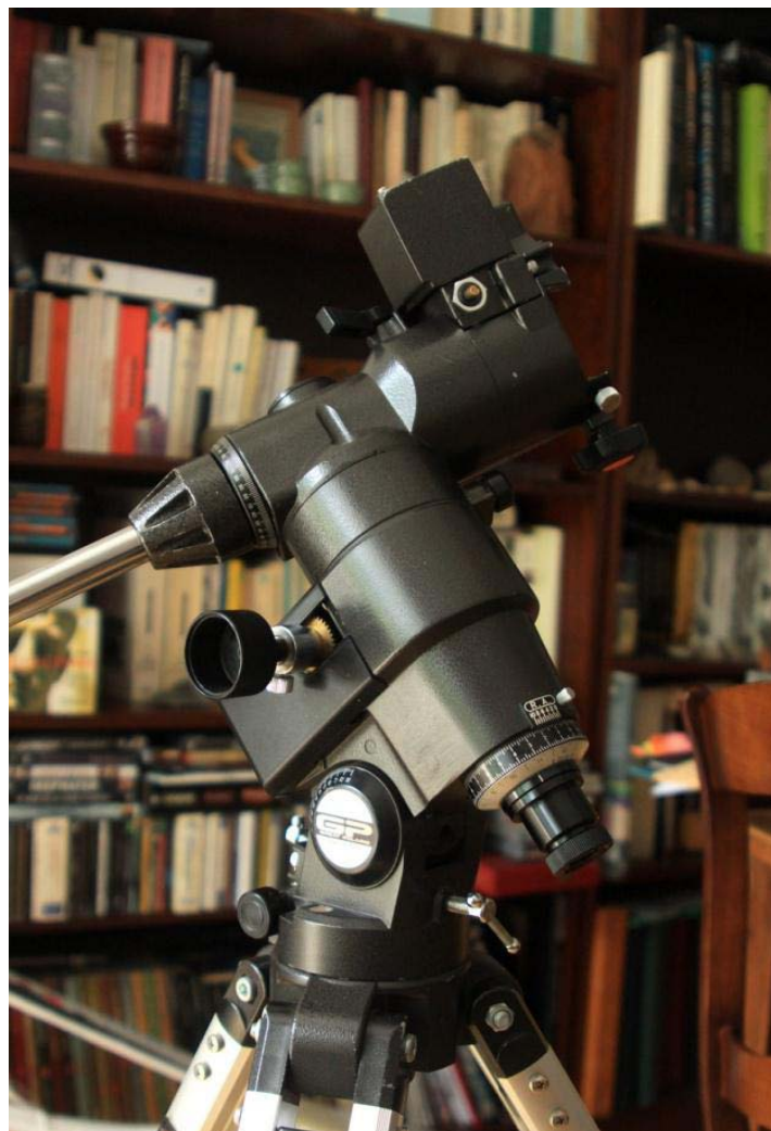
Figure 2 : position des cercles gradués sur une monture équatoriale (Great Polaris)
