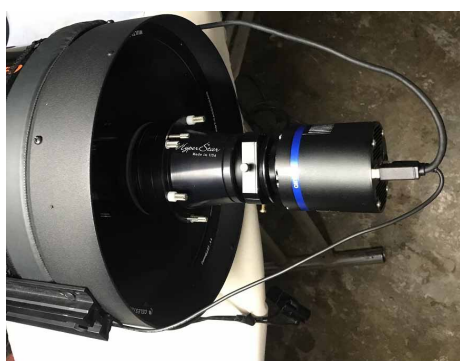
Préparation et montage de l'ensemble Hyperstar/tiroir/caméra sur le C11
