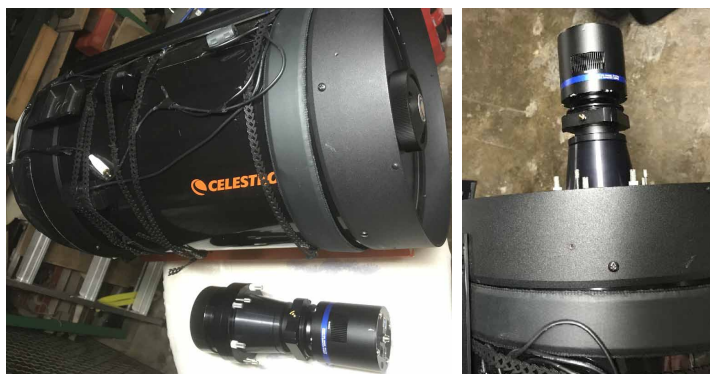
Préparation et montage de l'ensemble Hyperstar/tiroir/caméra sur le C11
