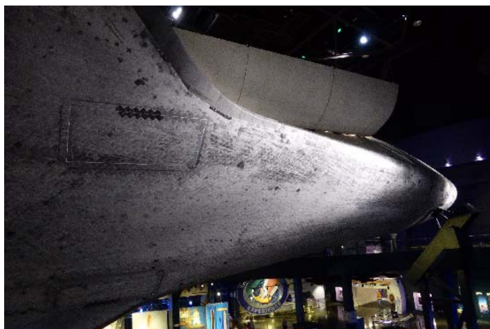
Vue de dessous: le bouclier thermique. Il est composé d'un assemblage de petites tuiles en céramique.
