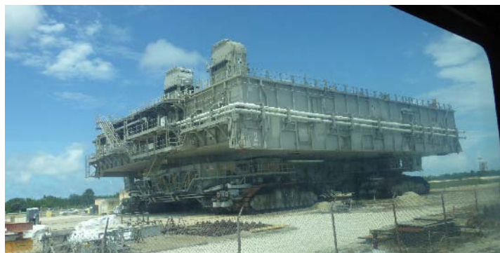
Le crawler: transport de la fusée et de la navette du V.A.B. vers le pas de tir
