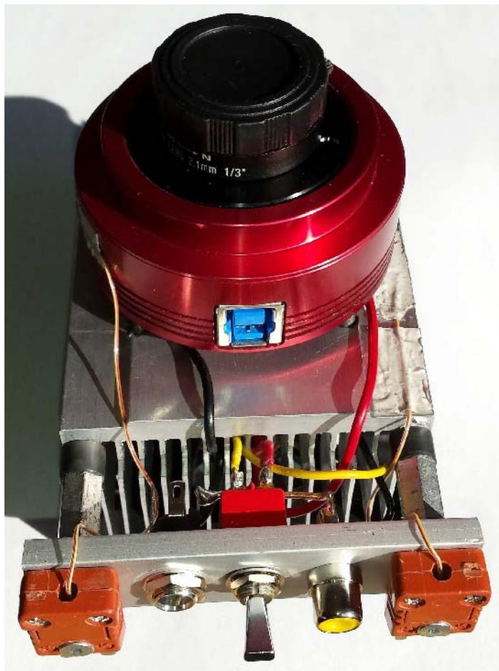
Ce montage réalisé pour une caméra ZWO peut être adapté à d'autres modèles de caméra. La ZWO présente un avantage au regard de ses dimensions : Elle est courte (cela import peu) mais d'un diamètre de 60 mm offrant une bonne surface plane de contact pour le transfert thermique.
