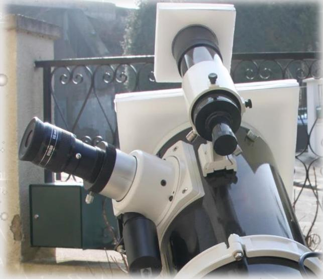
Feuille Baader Astrosolar collée sur du polystyrène de 5mn d'épaisseur. Celui-ci s'emboîte sur la bouche du newton et du chercheur.
